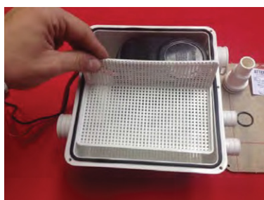
Fig. 3: Rimuovere la rete filtrante dalla base per avere libero accesso alla pompa di sentina.
