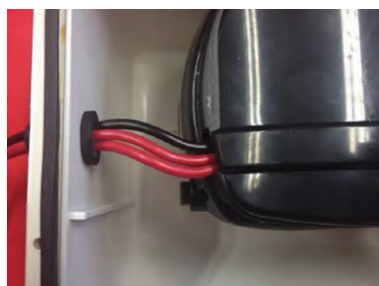
Fig. 7: Posizionare i tre cavi elettrici della pompa e contrassegnare il cavo ROSSO CENTRALE come positivo (+) che regola l'automatismo e il cavo ROSSO BASSO come polo positivo (+). Il cavo NERO è il terminale negativo (-).
